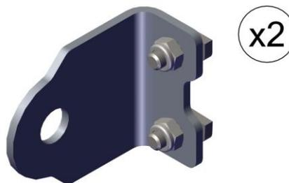
Placer 2 équerres EQUERRE FLEEX-V ANCRAGE - A0012351 à **10 mm** du haut de la barre de sortie, dos aux équerres précédemment installées
