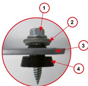
Alors qu'une vis autoforeuse standard évacue la matière du perçage en copeaux, la vis Drillnox DBS2 6x27 refoule la matière vers l'intérieur en formant un bourrelet, ce qui augmente la longueur d'implantation.
