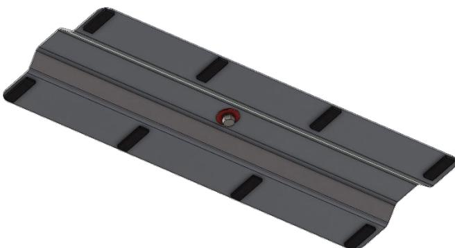
Une fois positionnée sur le bac aluminium, perçage de la tôle avec une mèche diamètre 8mm, et mise en place des 16 rivets BulbTite 7.7 avec une riveteuse manuelle ou électrique adaptée.
