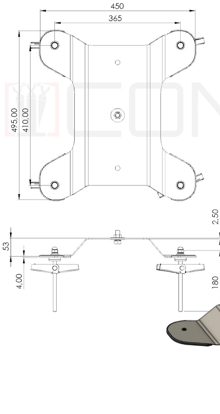
**Descriptif :** Les interfaces ICZ sont des interfaces spécifiquement développées pour installer les systèmes antichute CONEKT sur les toitures zinc. Ce produit est idéal pour la sécurisation antichute des toitures parisiennes haussmanniennes en zinc.
