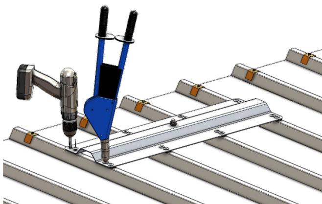
La platine ICA peut être utilisée comme interface pour ligne de vie câble ou rail CONEKT ou pour tout type de point d'ancrage CONEKT.
