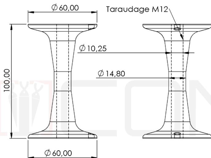
*Descriptif : Le diablo permet de fixer un absorbeur ou un tendeur de la gamme CONEKT sur les interfaces sur couverture de type ICJD, ICZ, ou ICA.*
