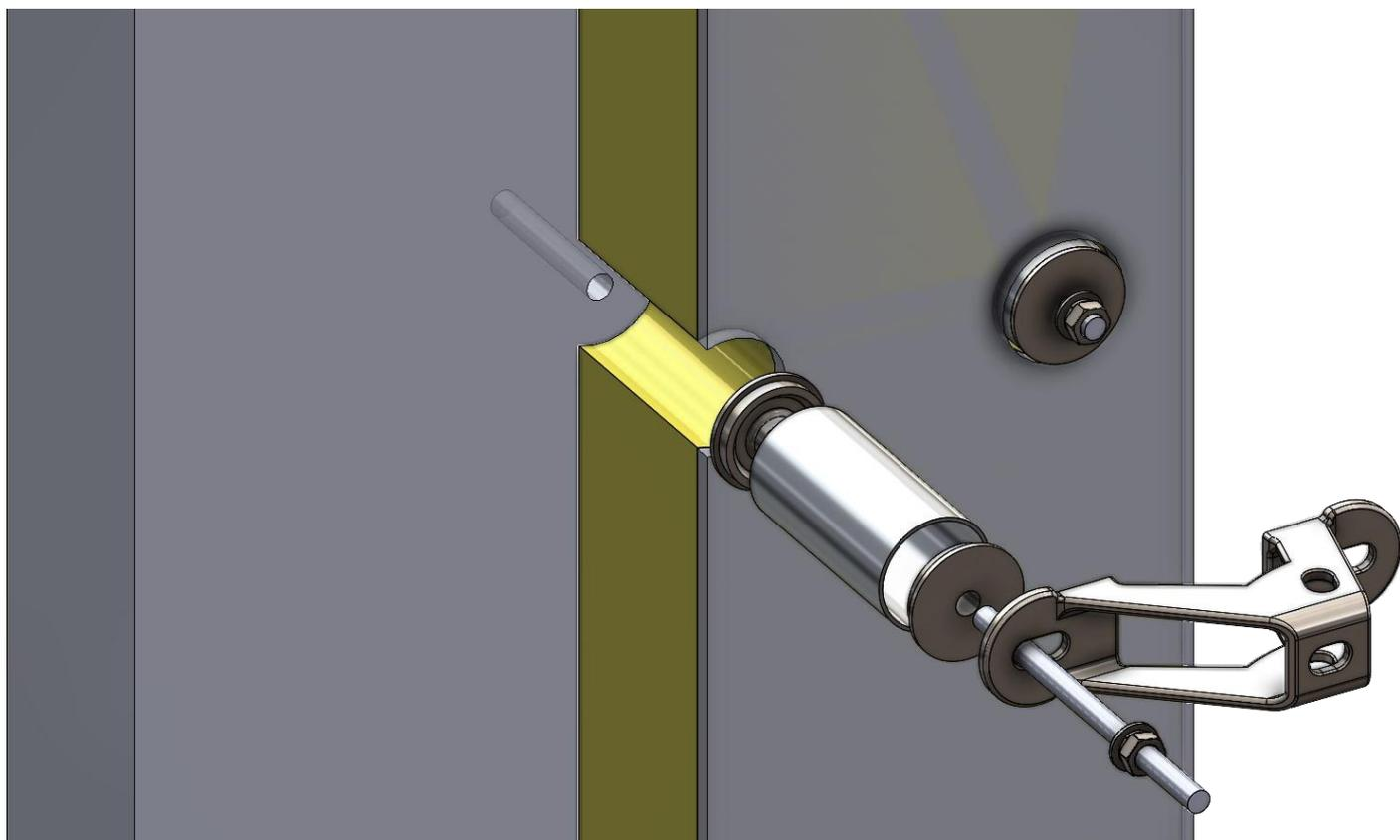
Le système se bride par l'intermédiaire de 4 vis M12 lg 80mm et 2 vis de liaison entre les supports de crapauds (en jaune). Les vis M12 de liaison doivent mesurer L+60mm. L étant la largeur de l'aile. Ce système peut s'adapter sur des ailes de 3 à 25mm d'épaisseur et de 60mm à 1m de largeur. Une vis M12 de 40mm doit être positionner au montage pour recevoir le support de ligne de vie.
