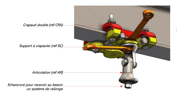
Le système de rallonge composé d'un tube de 60\*3 en aluminium, d'une tige filetée M12 et d'un support de rallonge SR permet de récupérer le niveau. La tige filetée doit mesurer la longueur du tube +50mm :
