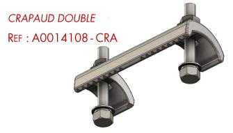
Crapaud double en acier galvanisé, avec 2 vis M12 longueur 80mm. Le crapaud double permet de « pincer » l'aile d'un profil métallique de 3 à 25mm d'épaisseur. La pièce possède un « grip » permettant d'améliorer sa résistance au glissement.
