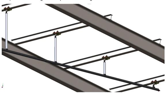
Le système se bride par l'intermédiaire de 4 boulons M12 de 80mm et 2 boulons de liaison entre les supports de crapauds (en jaune). Les fixations de liaison doivent mesurer L+60mm si ce sont des boulons M12 ou L+90mm si ce sont des tiges filetées. L'étant la largeur de l'aile du profilé métallique.
