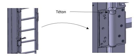
7. Une fois l'installation assemblée, vérifier que la porte s'ouvre correctement et automatiquement pour CEC300 et se ferme automatiquement pour CEC100. Vérifier la présence du téton, ce dernier peut tomber si les paumelles ne sont pas suffisamment en tension. Effectuer un essai de fonctionnement de la pédale de déverrouillage au pied positionnée sur l'opercule.
