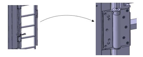
6. Quand la tension du ressort est suffisante, insérer le téton dans l'un des trous utilisés dans l'opération précédente, qui est situés entre les deux parties de la paumelle.
