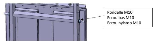
4. Monter la gâche de verrouillage sur le rail (KIT 1S016) à l'aide des vis H M6x20 + rondelles M6. La caler sans laisser de jeu contre la pièce en plastique collée contre la têtière de la serrure. Ajuster si besoin. Percer ø5 dans la gâche et sur le support KIT1S016 et mettre en place les 2 rivets Ø 4.8x16 pour verrouiller la position de la gâche sur le kit de fixation. ATTENTION: ouvrir la condamnation et retirer la cale plastique maintenue par les 2 adhésifs.
