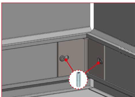
**3** - Insérer l'angle dans les rainures de la plinthe et fixer avec 2 vis cuvette M8x10.
