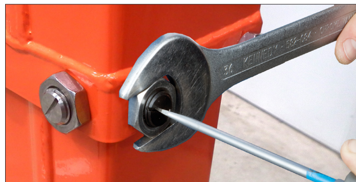
Réglage de la vis d'usure du mât
