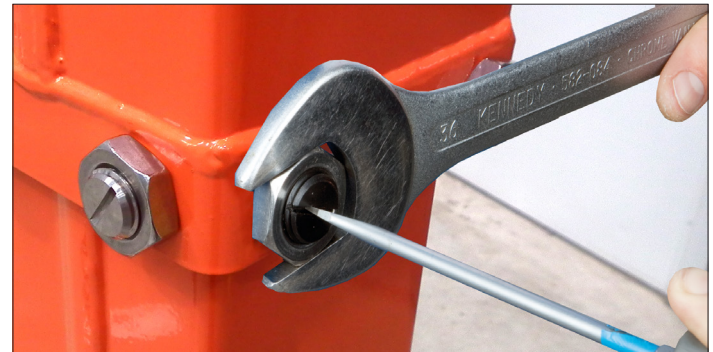
Réglage de la vis d'usure du mât
