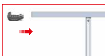
4 - Poser la main courante sur les montants. Fixer la en vissant la vis HC M08x40. Couple de serrage recommandé 15 N.m.
