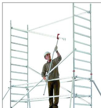
Système de connexion rapide des lisses et diagonales
