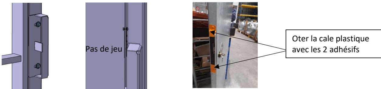
5. Utiliser les 2 tiges de poussée et les tétons prévus à cet effet afin mettre les paumelles en tension (se référer à la notice « réglage des ressorts »). Reprendre le remontage avec la seconde tige lorsque la première arrive en butée contre le montant de l'échelle pour ouverture automatique pour issue de secours CEC300. Pour une fermeture automatique (CEC100), régler la tension des 2 paumelles (haute et basse) pour avoir une vitesse de fermeture appropriée.
