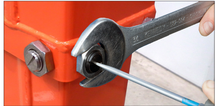
Réglage de la vis d'usure du mât
