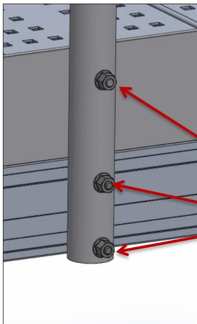
Vis M8x55 et écrou M8 (X1)
