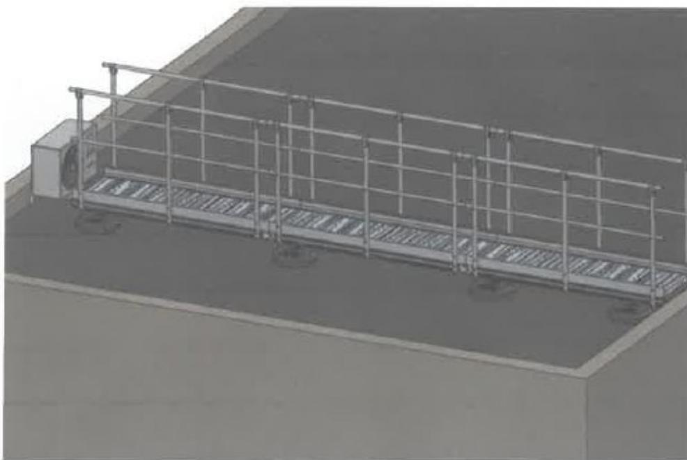
L'Echelle Européenne atteste que ses passerelles de toiture installées sur toitures étanchées sont conformes aux normes NF E85-15 et NF EN ISO 14122-3 lorsque celles-ci ont été installées dans le respect de la documentation technique.
