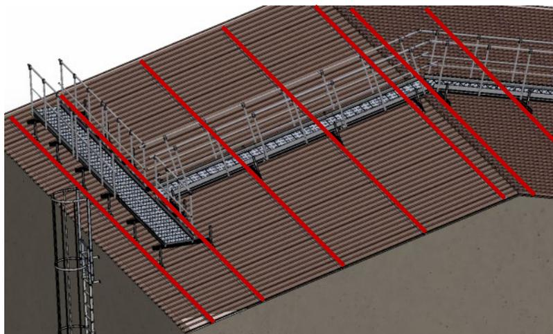
**d. Disposition des pieds dans le cas d'une liaison en T et d'une liaison en L**
