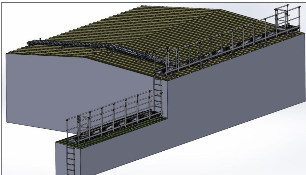
Les trois kits pieds sur bac acier **A0011707**, **A0011708** et **A0011709**, respectivement pour des pentes allant de 1 à 15°, de 16 à 30° et de 31 à 45°, permettent d'installer les passerelles sur les toitures en bac acier aussi bien dans le sens de la pente qu'à la perpendiculaire de la pente.
