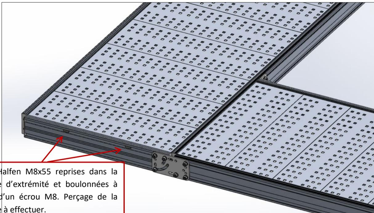
2 vis Halfen M8x55 reprises dans la marche d'extrémité et boulonnées à l'aide d'un écrou M8. Perçage de la marche à effectuer.
