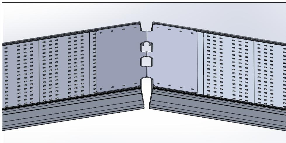
Pour lier deux passerelles avec changement de pente, utiliser un des kits de liaison passerelles pentes **A0011691** (Largeur 600) ou **A0011692** (Largeur 800).
