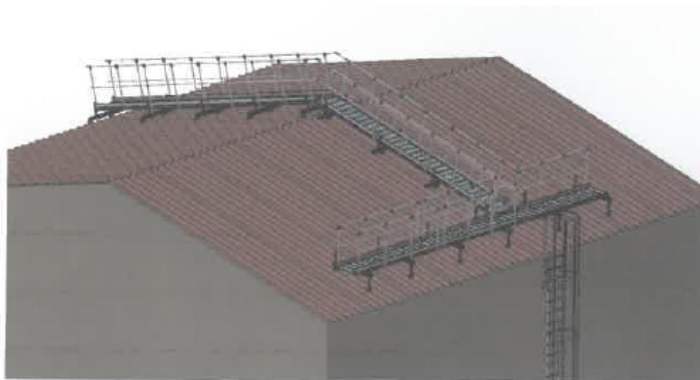
L'Echelle Européenne atteste que ses passerelles de toiture installées sur toitures ondulées sont conformes aux normes NF E85-15 et NF EN ISO 14122-3 lorsque celles-ci ont été installées dans le respect de la documentation technique.
