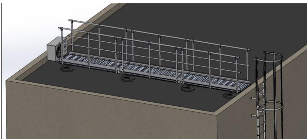
Le kit pieds sur plots lestés (A0011706) permet d'installer les passerelles sur les toitures bétons et les toitures étanchées à faible pente.
