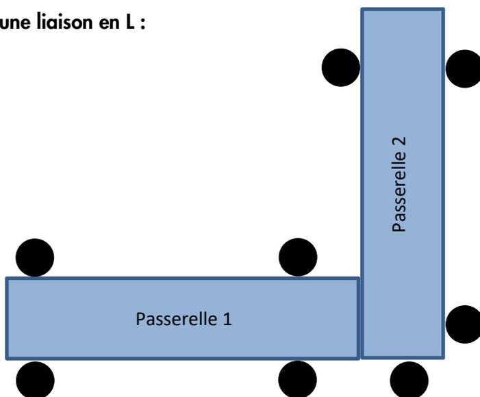
**d. Disposition des pieds dans le cas d'une passerelle orientée dans le sens de la pente.**
