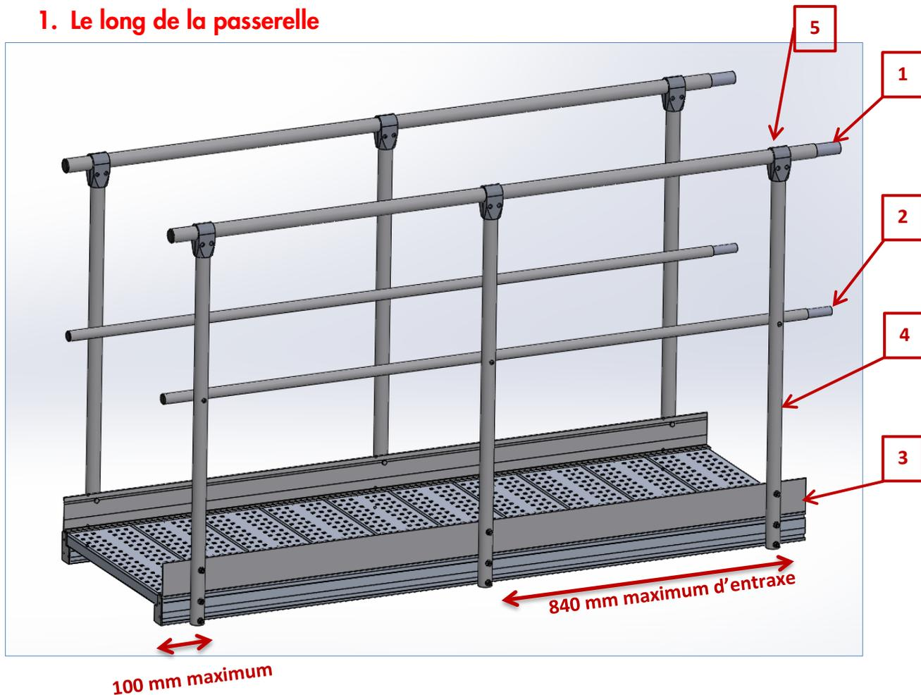
Les Garde-Corps de passerelle sont constitués des éléments suivants :
