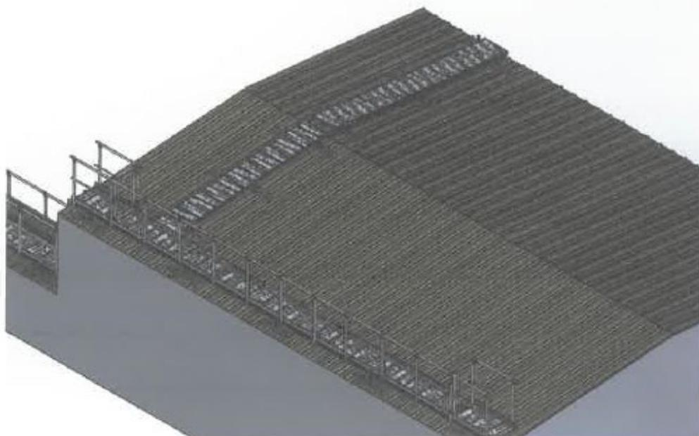
L'Echelle Européenne atteste que ses passerelles de toiture installées sur toitures en bac acier sont conformes aux normes NF E85-15 et NF EN ISO 14122-3 lorsque celles-ci ont été installées dans le respect de la documentation technique.
