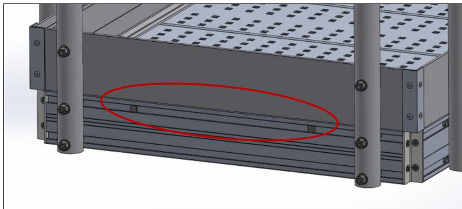
2 vis Halfen M8x55 reprises dans la marche d'extrémité et boulonnées à l'aide d'un écrou M8. Perçage de la marche à effectuer.
