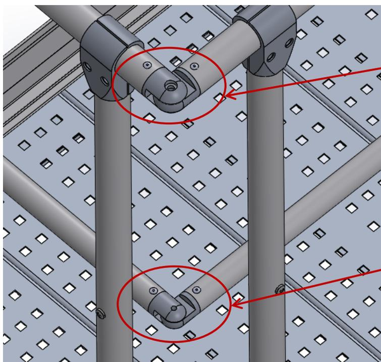
Pièces de raccord d'angle pour main courante rivetées.
