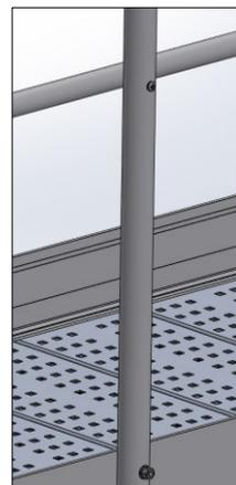
La lisse est maintenue au poteau à l'aide d'un raccord de main courante en T.
