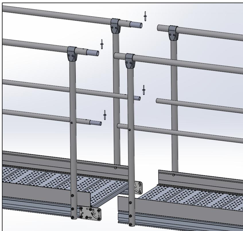
Les lisses et sous lisses de garde-corps peuvent être prolongées à l'aide des tubes de liaison Ø35mm (pour les lisses) et Ø25mm (pour les sous lisses). Ils sont maintenus ensemble à l'aide de rivets.
