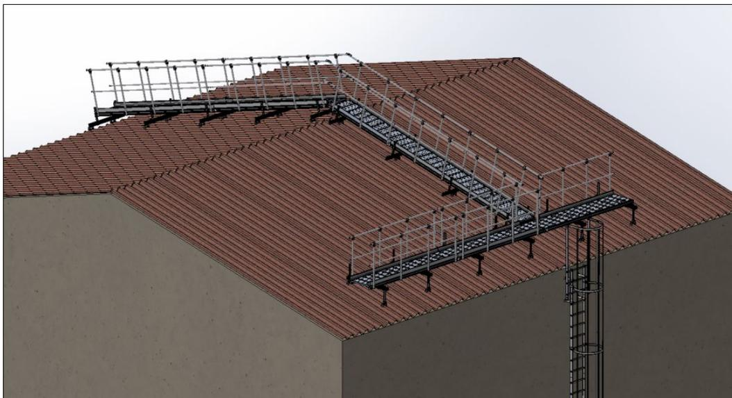
Les quatre kits pieds sur tôle ondulée **A0011711**, **A0011712**, **A0011713** et **A0011710**, respectivement pour des pentes allant de 1 à 15°, de 16 à 30°, de 31 à 45° et pour l'installation dans le sens de la pente, permettent d'installer les passerelles sur les toitures en tôle ondulée dans le sens parallèle et perpendiculaire à la pente.
