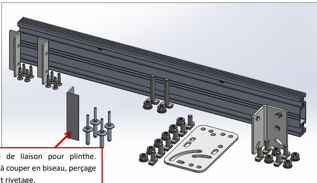
Cornière de liaison pour plinthe. Plinthes à couper en biseau, perçage  $\varnothing 5\text{mm}$  et rivetage.
