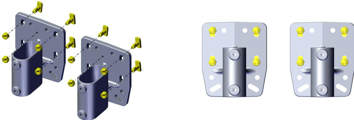
Fixer les deux étriers de chaque côté de la plate-forme à 941 mm par rapport à l'extrémité de la plate-forme.
