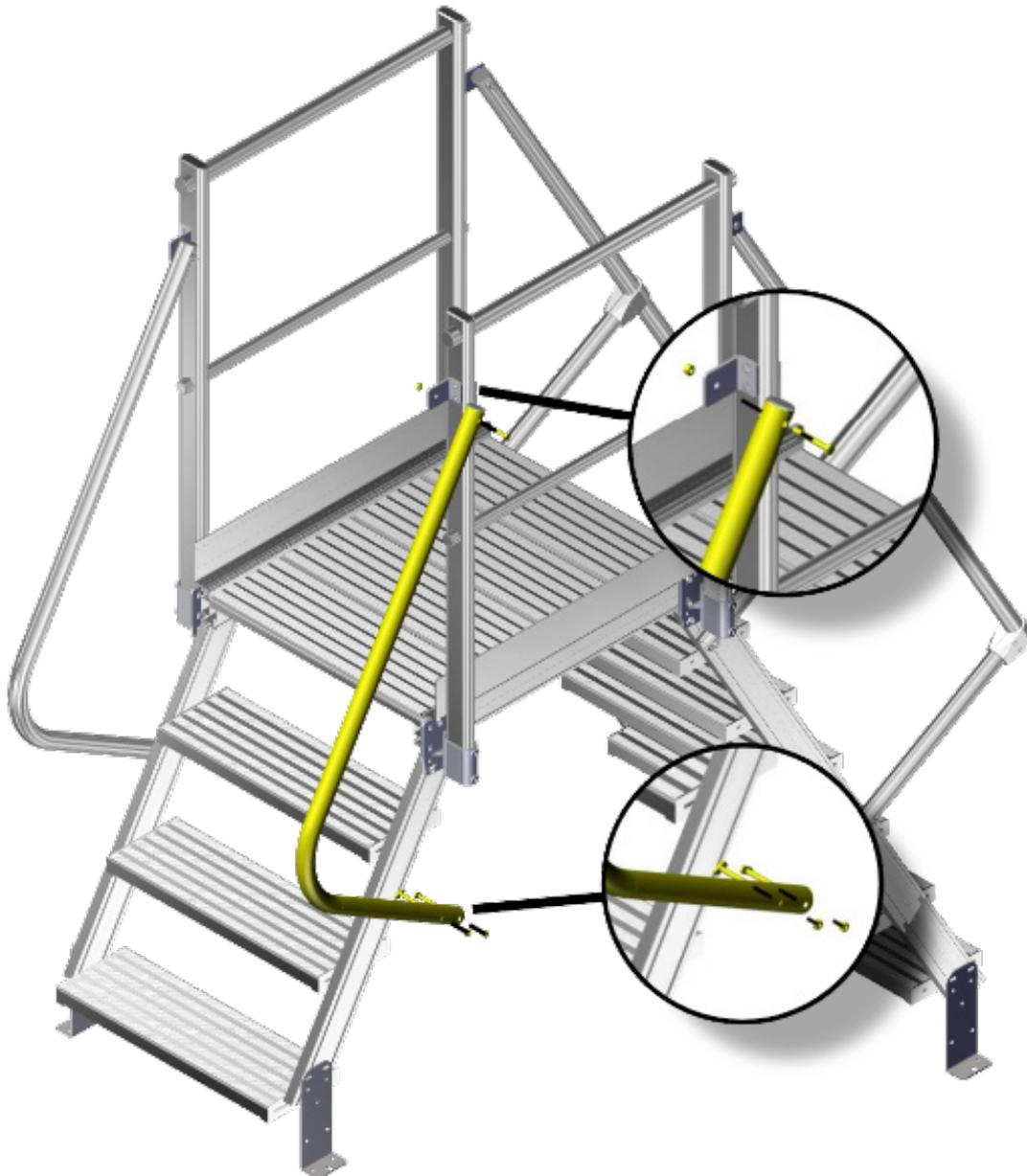
**En partie haute**, pré-serrer une vis H M8x60 qui traverse à la fois la cornière du garde-corps et la main-courante.
