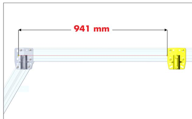
Desserrer les vis pointeaux des étriers puis enficher les poteaux dans les emplacements prévus. Placer les poteaux en mettant les 3 trous de perçage sur l'extérieur.
