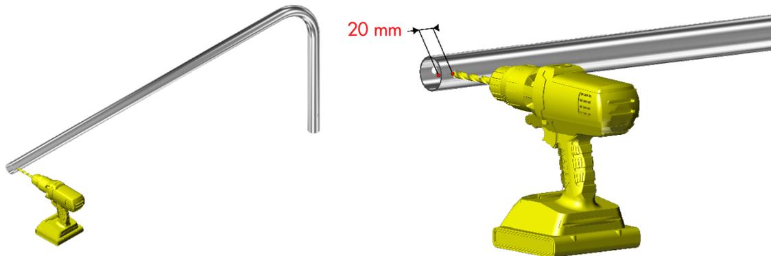
3. **Mettre les bouchons** sur les mains-courantes du côté de l'extrémité découpée et percée.
