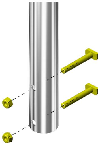
Positionner la brinck sur le poteau. A l'aide d'une équerre, ajuster le poteau de sorte que la brinck soit à fleur de la main-courante. Pré-serrer les vis sur le limon.
