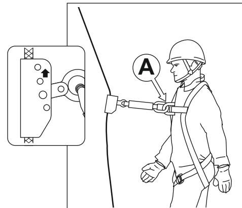
**ATTENTION :** Avant toute utilisation de l'équipement de protection contre la chute de hauteur pour lequel on utilise le dispositif LINOSTOP II ED, il faut vérifier si tous les éléments sont connectés de manière correcte et fonctionnent comme il faut, et qu'ils remplissent les exigences des normes appropriées :
